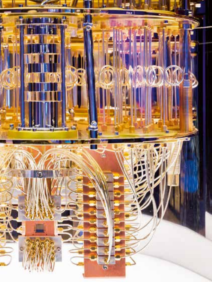
04 Interior de un sistema de computación cuántica IBM El chip cuántico está situado en el pequeño cuadrado oscuro en la parte inferior central.
